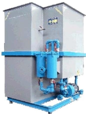
Установка предназначена для переработки нефтемасло-отходов и замазученных стоков в добавки к печному топливу или в печное топливо.
