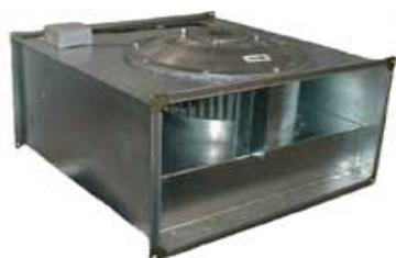
Вентиляторы канальные прямоугольные (ВКП) применяются в системах приточно-вытяжной вентиляции промышленных и общественных зданий. Они компактны и легко монтируются в любом положении. Подсоединяются с помощью гибких соединений с фланцами на шинорейке.
