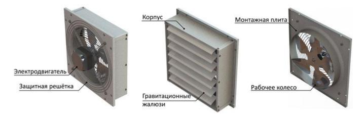
Корпус вентилятора выполнен из стали с порошковым покрытием. Рабочее колесо изготовлено из алюминия, защищено хромированной сеткой. В комплект входят гравитационные жалюзи. Двигатель со встроенным температурным реле, класс защиты электродвигателя вентилятора - IP 42. Бесшаговый тиристорный регулятор скорости обеспечивает плавное регулирование скорости вращения.
