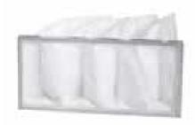
**Вставки карманного типа KF3** (класс фильтрации EU3), KF5 (EU5) и KF7 (EU7) предназначены для фильтров KFD. Оптимализацией формы карманов и новым способом прошивания удалось достичь снижения потерь давления, повышения поглощающей способности и долговечности. Материал изготовлен из нетканых синт. волокон с теплостойкостью до 100°C. Вставки закреплены в рамке из оцинкованного листа.
