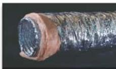
**SonoDFA** - звукопоглощающие гибкие воздуховоды с перфорированной основой DFA и стандартной теплоизоляцией толщиной 25 мм. Защитный рукав выполнен из многослойной полиэфирной металлизированной ленты армированной лавсановой нитью. Рабочая температура от -30° С до + 120° С. Максимальное давление 2000 Па. Длина воздуховодов 10 метров.
