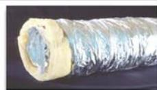
**SonoDF-S** - звукопоглощающие гибкие воздуховоды с перфорированной основой DF с пароизоляцией и стандартной теплоизоляцией толщиной 25мм. Защитный рукав выполнен из полиэфирной металлизированной ленты. Рабочая температура от -30° С до + 120° С. Максимальное давление 2400 Па. Длина воздуховодов 10 метров.
