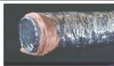
**ISODF** - теплоизолированные воздуховоды с основой DF и стандартной теплоизоляцией толщиной 25 мм. Рабочая температура от -30° С до +120° С. Максимальное давление 2400 Па. Длина воздуховодов 10 метров.
