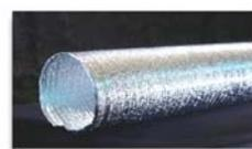
**DFA** - гибкие воздуховоды сделанные из алюминиевой фольги ламинированной полиэфирной лентой, со спиральным каркасом из стальной проволоки. Рабочая температура от -30° С до + 140° С. Максимальное давление 2400 Па. Длина воздуховодов 10 метров.
