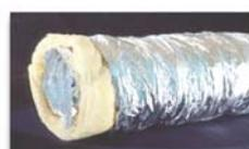
**SonoDFA-S** - звукопоглощающие гибкие воздуховоды с перфорированной основой DFA, пароизоляцией из прозрачной полиэфирной ленты и стандартной теплоизоляцией толщиной 25 мм. Защитный рукав сделан из алюминиевой фольги, ламинированной полиэфирной лентой и армированной лавсановой нитью. Рабочая температура от -30 до + 120° С. Максимально Давление 2400 Па. Длина воздуховодов 10 метров.
