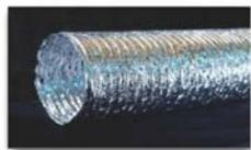
**DF** - гибкие воздуховоды выполненные из многослойной полиэфирной металлизированной ленты, со спиральным каркасом из стальной проволоки. Рабочая температура от -30° С до +120° С. Максимальное давление 2400 Па. Длина воздуховодов 10 метров.
