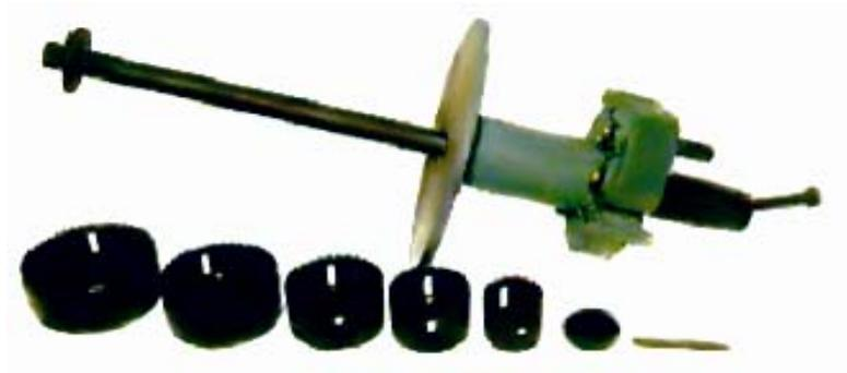
Устройство врезки в трубопроводы ВРТ-1 позволяет осуществлять врезку в магистральные и другие трубопроводы под их номинальным давлением, не отключая при этом потребителей. Рекомендуется при работах на действующих водопроводах.
