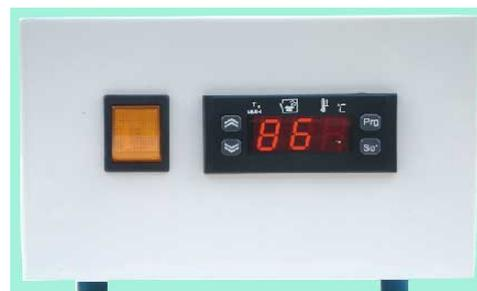
Блок управления обеспечивает возможность работы шкафа по четырем программам. Две программы фиксированные и настроены для работы шкафа при температурах 85 и 120 °С и времени выдержки 30 и 45 минут соответственно. Две другие программы настраиваются потребителем на температуру в пределах от 50 до 200 °С и время выдержки от 0 до 999 минут. При этом обеспечивается выполнение программ с точностью по времени  $\pm 1$  минута, по температуре  $\pm 3$  °С от заданных величин.
