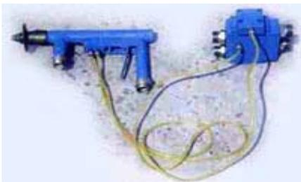
Пистолет "ВВП-1" предназначен для гидравлического разрушения илистых и наносных отложений на внутренней поверхности труб потоком водно-воздушной последующего удаления отложений.
