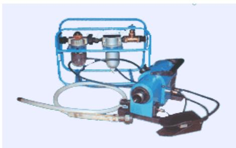
Установка "Крот" предназначена для гидромеханического разрушения карбонатных и илистых отложений на внутренней поверхности труб посредством вращающейся коронки зубчатой или насадки роликовой и последующего удаления отложений потоком жидкости. Качество очистки достигает 95-97%.
