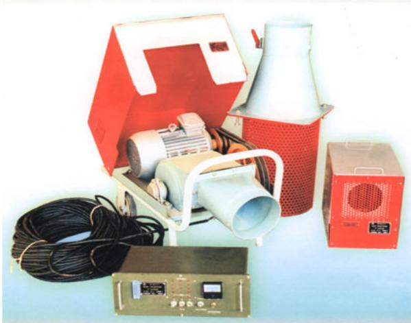
Предназначена для обеспечения электроэнергией бытовых устройств (теле и радиоаппаратуры, светильников, нагревателей, кухонного оборудования и т.п.), жилищ и других объектов, удаленных от линий электропередач и расположенных по берегам водотоков в местности, позволяющей производить забор воды величиной не менее 54 л/с и создавать гидравлический напор воды величиной не менее 6м на расстоянии не более 100м.
