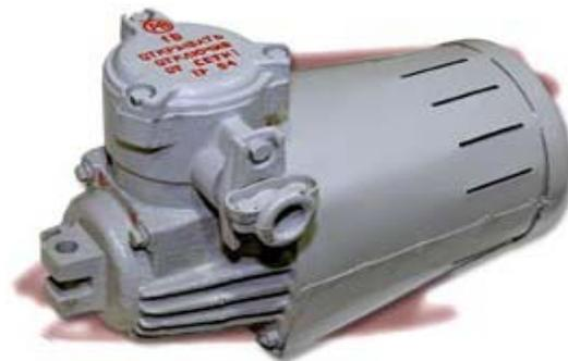
Толкатели поставляются заполненными трансформаторным маслом ГОСТ 982-80 с диапазоном рабочей температуры от -20<sup>0</sup>С до +40<sup>0</sup>С. Эксплуатация толкателей возможна при температуре ниже 20<sup>0</sup>С (до -40<sup>0</sup>С) при замене трансформаторного масла смесью трансформаторного масла (50%) с жидкостью ПЭС-ЗД ТУ6-02-688-76 (50%) или ПЭС-3 ГОСТ 13004-77.
