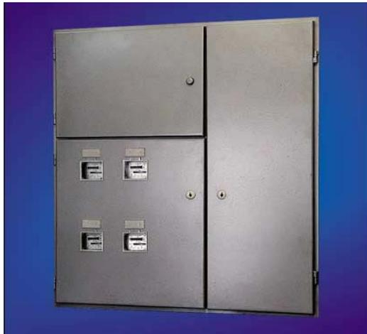
Щитки этажные серии ЩЭ предназначены для приема, распределения и учета электроэнергии напряжением 220 В, а также для защиты линий квартир при перегрузках и коротких замыканиях.
