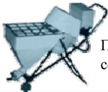
Предназначена для подачи по рукавам и нанесения на обрабатываемую поверхность малярных составов кроме взрывоопасных и ацетоносодержащих композиций, для небольших объемов работ.
