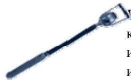
**Вибратор ИВ-102А** предназначен для уплотнения бетонных смесей при укладке их в монолитные конструкции с различной степенью армирования в гидротехническом строительстве, а также при изготовлении бетонных и железобетонных изделий для сборного строительства. Вибратор состоит из вибронаконечника, коробки выключателя и соединяющего их резиноканевого рукава.
