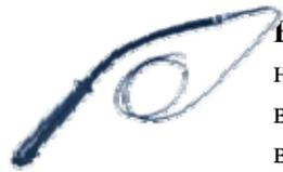
**Вибратор ИВ-95А** глубинный подвесной со встроенным двигателем предназначен для установки на бетоноукладчиках, входящих в комплект машин для скоростного строительства автодорог и взлетных полос аэродромов. Вибратор состоит из вибронаконечника и резиноканевого рукава со встроенным в нем кабелем.
