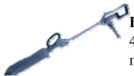
**Вибратор ИВ-103** предназначен для уплотнения бетонной смеси с осадкой нормального конуса 2-4 см при укладке в малоармированные массивы гидротехнических сооружений. Вибратор представляет собой цилиндрический комплекс, внутри которого встроены эл/двигатель и дебаланс.
