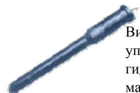
Вибратор электромеханический глубинный подвесной предназначен для механического уплотнения бетонной смеси слоями до 1,25м в неармированных и малоармированных блоках гидротехнических сооружений. Вибратор применяется в качестве навесного оборудования на малогабаритном электротранспорте, кране, кран-балке и т.д.
