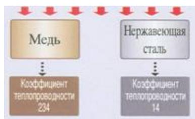
► Как показано выше при равной подаче тепла теплопроводность меди выше в 23 раза, поэтому эксплуатация котла, в котором применяется чистая медь, позволит сократить расходы топлива. Данная модель котла экономична.
