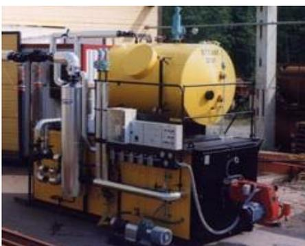
котлоагрегат STEAM 3000 при готовности к отправке с завода в г. Ристиина (Финляндия)
