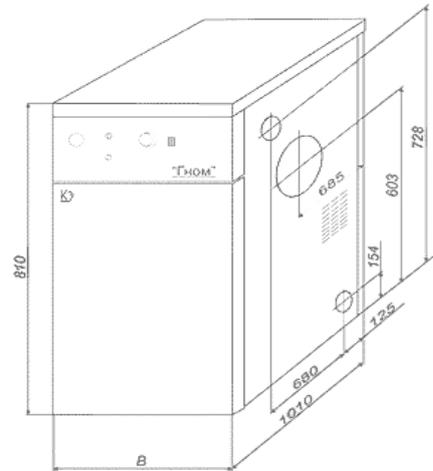
Котлы газовые отопительные водогрейные чугунные секционные типа КЧМ-7 „ГНОМ”, предназначены для теплоснабжения зданий, сооружений и жилых домов строительным объемом до 2700 м<sup>3</sup>, оборудованных системой отопления с естественной или принудительной циркуляцией теплоносителя.
