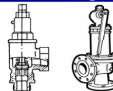
Клапаны предохранительные предназначены для автоматического или ручного сброса рабочей среды при превышении давления в защищаемых объектах сверх допустимого. Клапаны работают в диапазонах настройки пружины на определенное давление.
