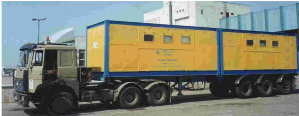
Установка вырабатывает до 1000 м<sup>3</sup>/ч газообразного азота чистотой 90,0%. С повышением концентрации продукционного азота его выход уменьшается.
